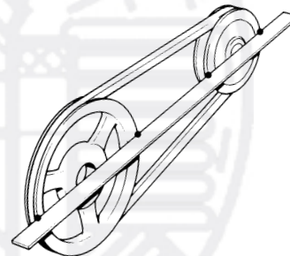
Abb. 41 Ausrichten der Riemenscheiben
