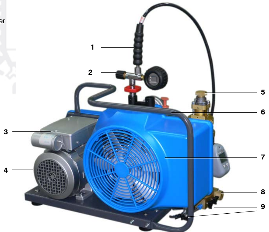
Abb. 3 Kompressoranlage mit Elektromotor (Wechselstromausführung)
