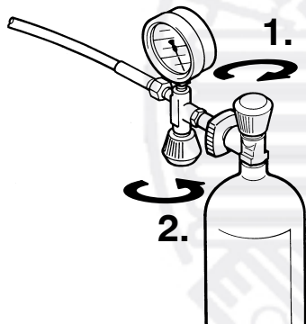
Abb. 10 Abnehmen der Druckluftflaschen
